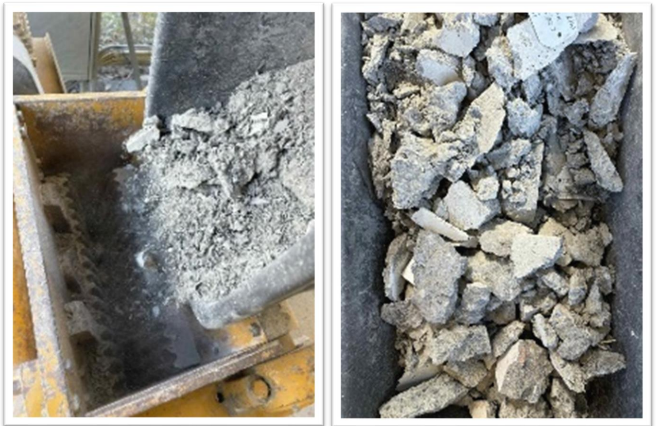
Figur 4 Krossade betongkuber som nyttjas betongballast
