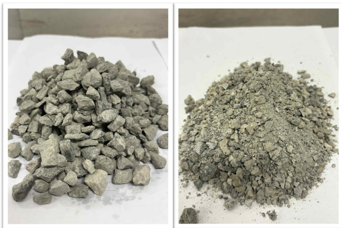
Figur 3 Bergkross från Vällsta och återvunnen betongballast från Ale 0/16.
